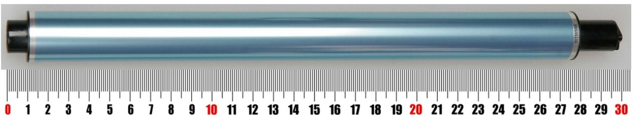
3. Покрытие на барабане прозрачное (свет отражается от алюминиевой поверхности барабана), это покрытие имеет при обычном освещении голубые оттенки. Общая длина барабана 300 мм.
